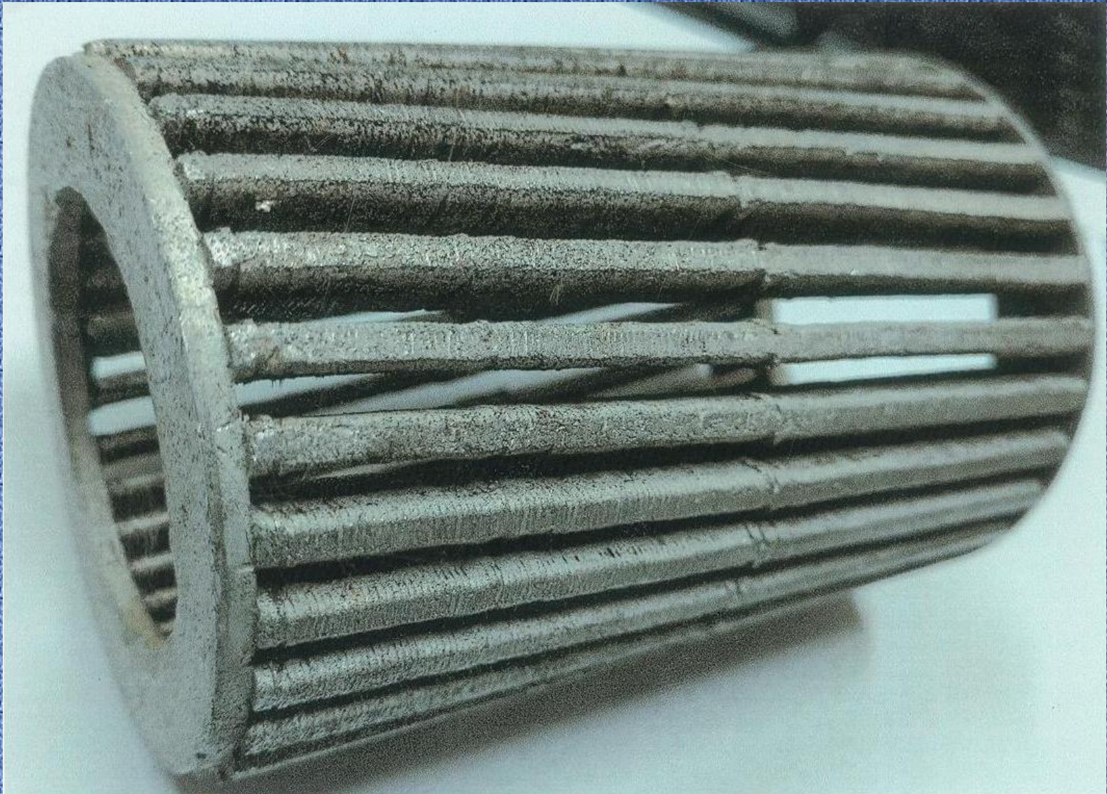
Detalle de jaula de ardilla inyectada en aluminio (1)
